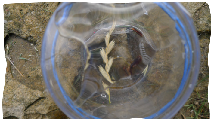
Kelímkové lupy lze vyrobit z průhledného kelímku, folie, gumičky a kapky vody. Získáme 2x zvětšení.
