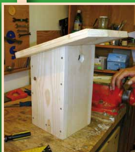
Střechu či stěnu připevníme na panty tak, abychom budku mohli otevřít a každoročně nejlépe na podzim vyčistit. Ptáci si totiž každoročně staví nová hnízda a v těch starých se často zdržují nežádoucí ptačí cizopasníci.
