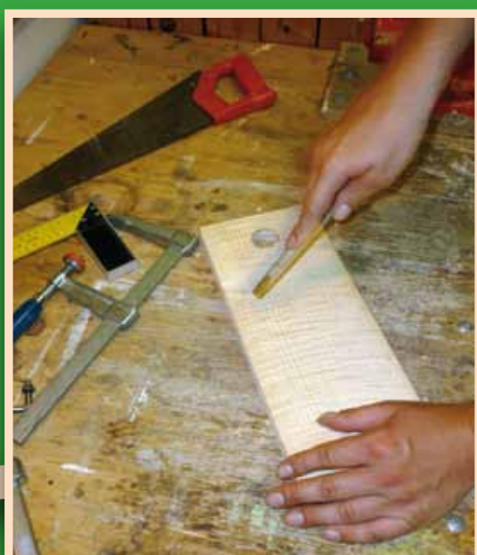
Vnitřní stranu čelní stěny zdrsníme v případě, že jsme použili oboustranně hoblovaná prkna. Umožníme tak ptákům snadnější opuštění budky.
