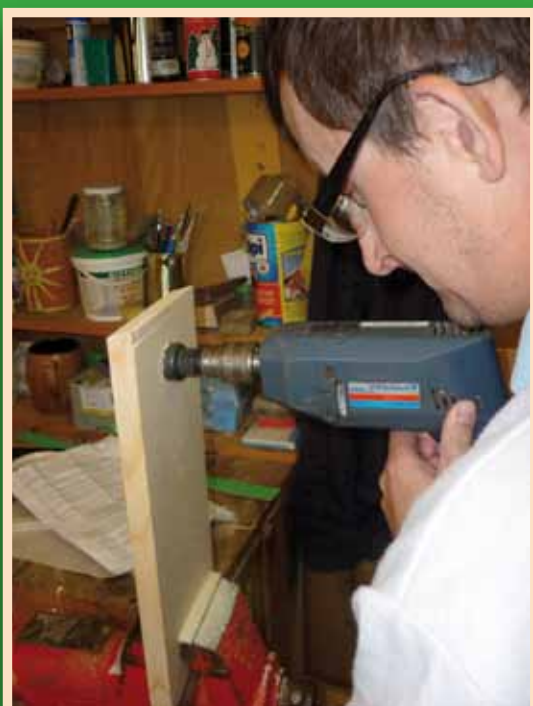
Vyvrátíme otvor k vletu. Velikost viz tabulka.
